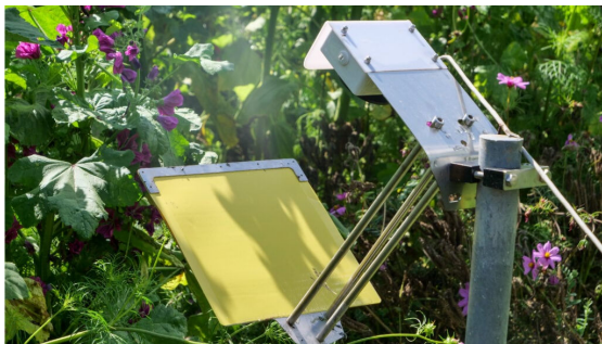
Abbildung 8: Insektenkamera mit gelber Klebefläche, positioniert inmitten der Blühfläche. Quelle: Telekom AG, 2023
