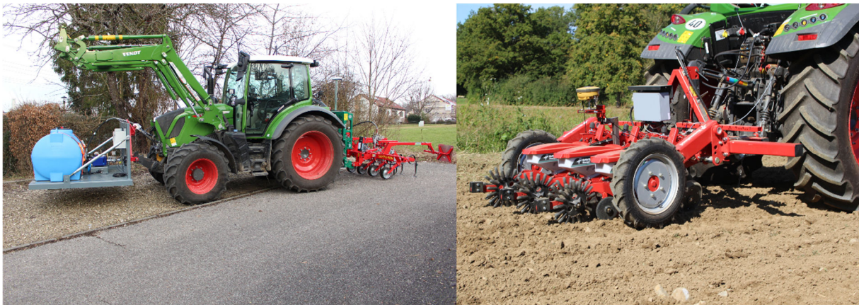
Abbildung 25: Links im Bild ist der Stand des Prototyps im Januar 2024 zu sehen. Rechts ist die Sämaschine mit integrierter Messtechnik abgebildet.
